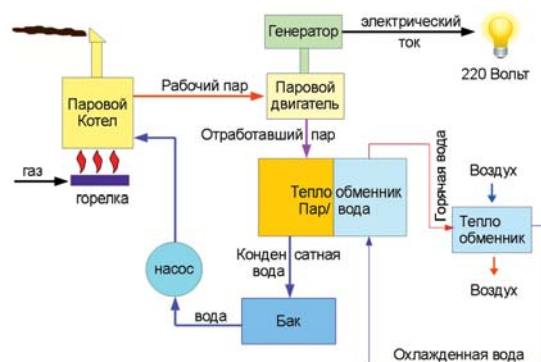
Рис. 7. Принципиальная схема прототипа КГУ «КРОПАТ»
